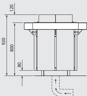
Zuluft über Zuluftkanal ggf. mit Lüfter
