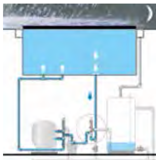
Spaarstand, afzuiging via bodempot i.p.v overloopgoot (buffer), indien afdekking gesloten is.
