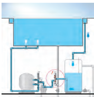
Normale schakeling buffertank/overloopgoot.
